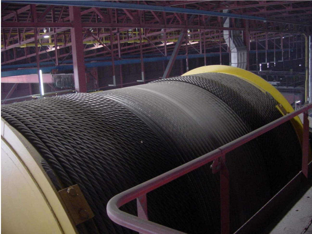
Haupthubwerk eines 250 t Gießkranes (VA-Stahl Linz, Kranbau Köthen)
