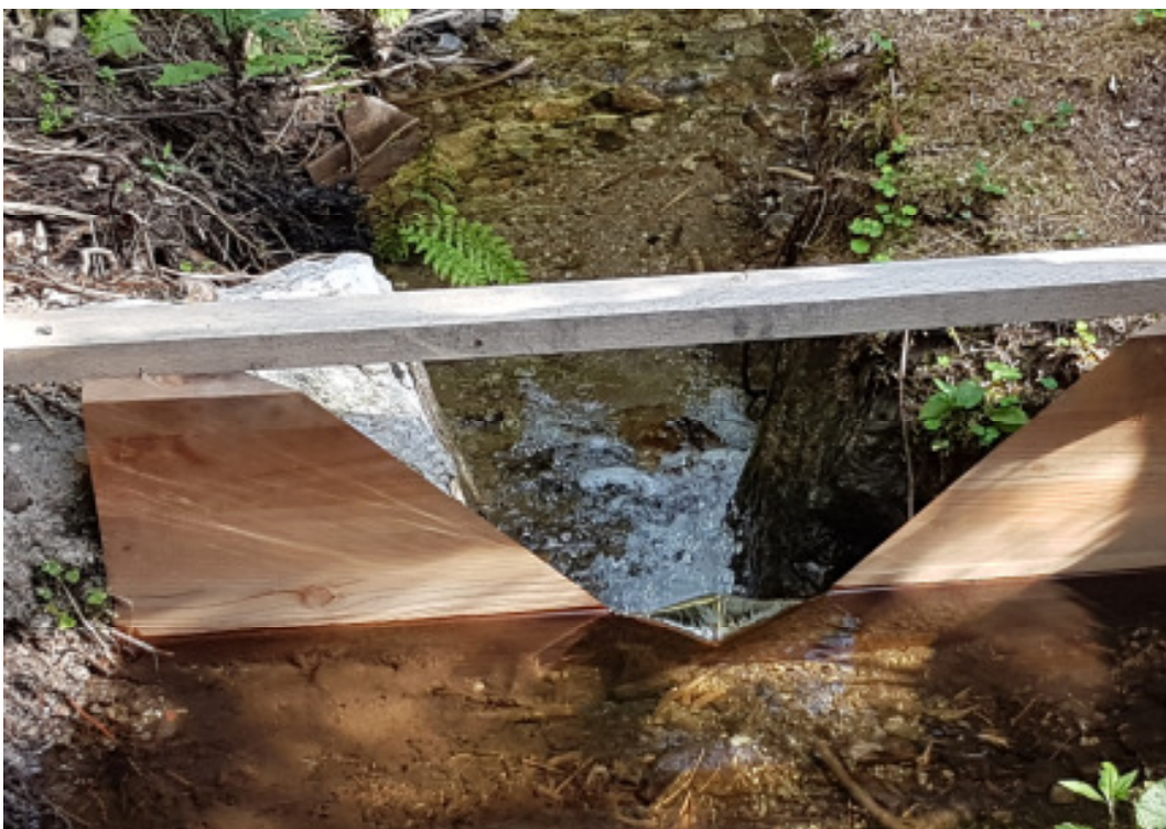
Bild 1.1: Abflussmessung im Quellbach zum Koppenbach
