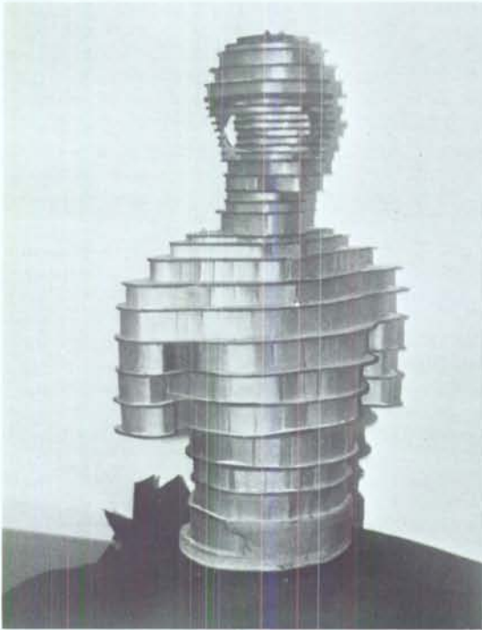
Abb. 1: Querschnitte von Torso und Kopf eines Test-Manikins mit Wellpapiereinlagen.
