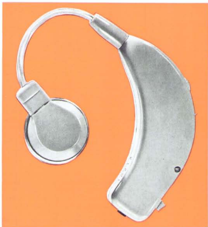
Der Ohrmuschelhänger mit außen angebrachtem Hörer
