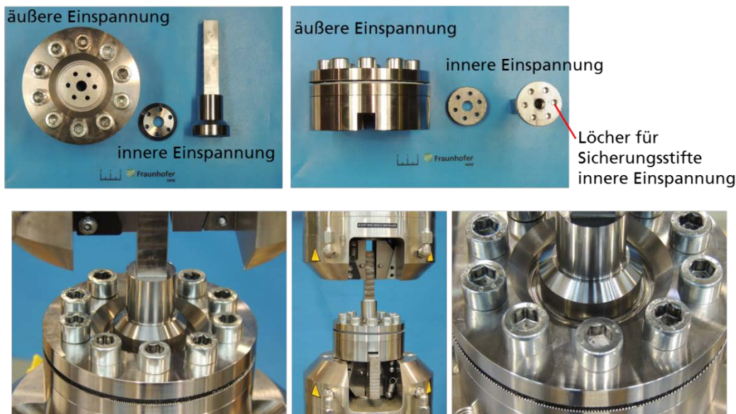
Abbildung 4-52: Teile der Einspannung sowie gesamter Versuchsaufbau für den Prototyp einer gekerbten ebenen Blechtorsionsprobe
