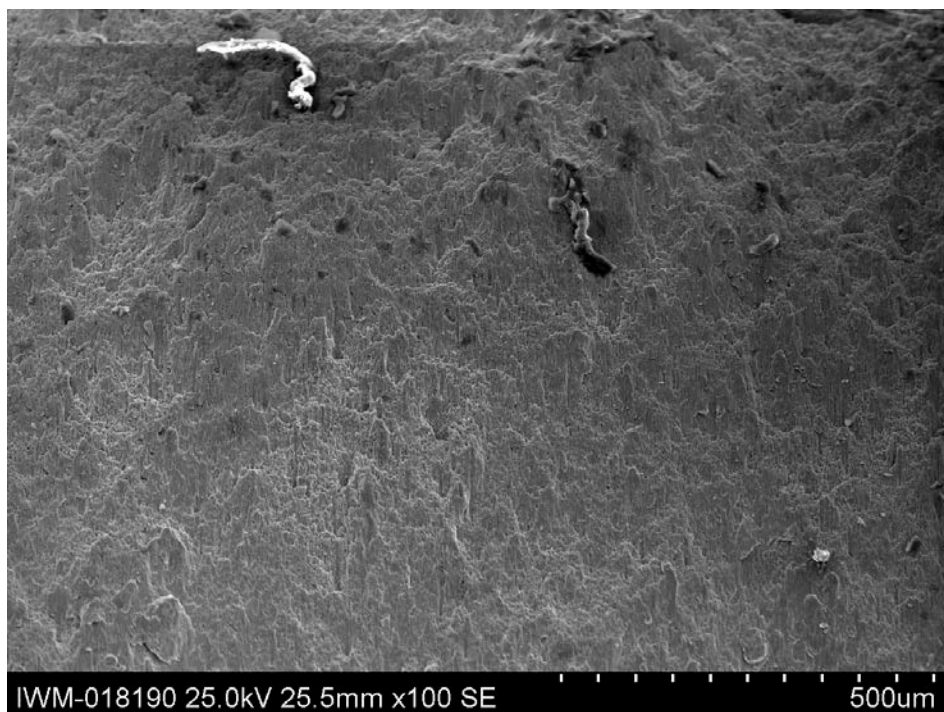
Abbildung 13-12: REM-Aufnahme (oberer Bereich der Bruchfläche von unsymmetrischer A-Probe für HX340LAD, AFZ1-Sz-A-01)
