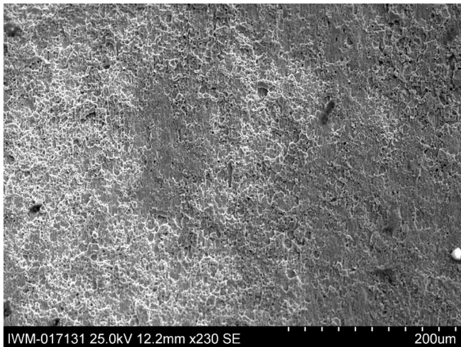
Abbildung 13-7: REM-Aufnahme ( oberer bis mittlerer Bereich der Bruchfläche von symmetrischer C-Probe für HCT980XG, AFZ2-Sz-Sym-C02)
