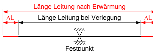
Bild 7.13 Schematische Darstellung der thermischen Ausdehnung.
