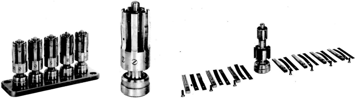
Die Auslassventile 6 für das komprimierte Kältemittel sind in das Gehäuse eingesetzt. Jeder Ventilkörper hat im Vieleck angeordnete Federlamellen, die durch den Gasdruck von ihrem Sitz abgehoben werden. Auf diese Weise ergeben sich grössere Durchgangsquerschnitte und damit geringere Strömungsverluste und bessere Wirkungsgrade.
