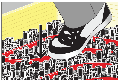
Abb. 44: Rohre entsprechend den Berechnungsdaten verlegen.
