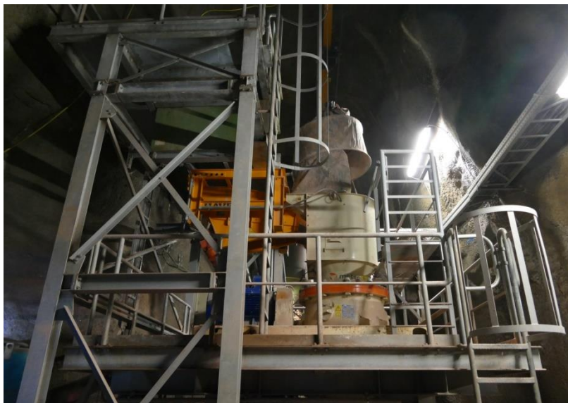
Abbildung 26: Röntgensortieranlage der Grube Niederschlag (links: Sortieranlage, rechts: Bandanlage)
