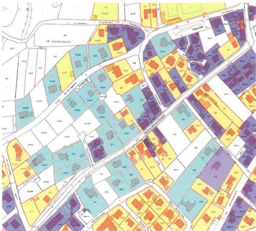
Abb. 64: Fläche mal Grundstücksabflussbeiwert [Quelle: RIWA-GIS, Memmingen]
