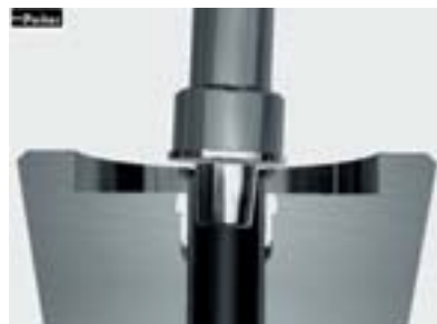
Sobald die flache Arbeitsfläche des Bördeldornes mit dem Rohrende in Berührung kommt, beginnt der Bördelvorgang
