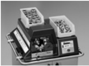
Behälter können auf den Plattformen gelagert werden
