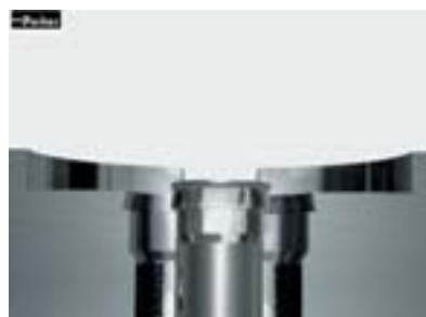
Das Ende des Rohrs wird freigegeben und kann aus der Maschine entnommen werden
