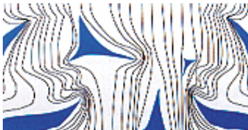
Verlauf der Spannungslinien bei Gusseisen mit Lamellengrafit (links), mit Kugelgraft (rechts)
