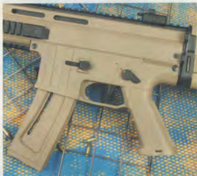
Die Flügelsicherung und der Magazinknopf sind von beiden Seiten zu bedienen. In den nicht vom Gehäuse verdeckten Schlitzen weiter oben erkennt man die Bohrungen für den Spannstift.
