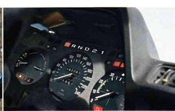
Die Instrumente bis 1982 sind opulenter als das spätere BMW-Einheits-Cockpit. Oben die Stufen des ZF-3-Gang-Automat
