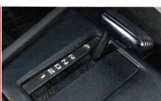
Typische BMW-Wählhebelkulisse mit Bürste und Knauf. Die Ganganzeige ist im Kombi-Instrument beleuchtet
