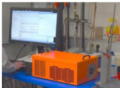
Berührungsloses Schichtdickenmessgerät CoatMaster bei der Messung im Labor
