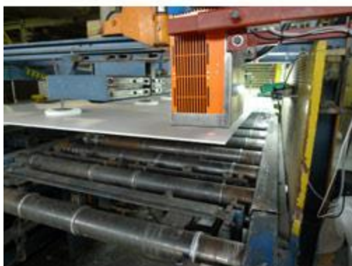
Schichtdickenmessgerät CoatMaster bei der Inline Prüfung von Nasslack auf Zementplatten
