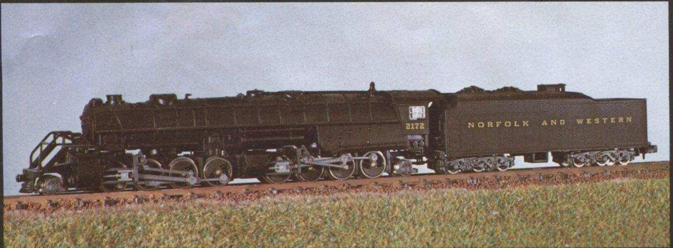
Modell der US Mallet-Lokomotive USRA 2-8-8-2 Y 6b in genau maßstäblicher Ausführung und feinsten Detaillierung aller Einzelheiten von Lok und Tender, alle Achsen angetrieben. Haftreifen, hochuntersetztes Getriebe, beleuchtete Frontlaterne, Länge 220 mm. 9001 »Norfolk and Western«
