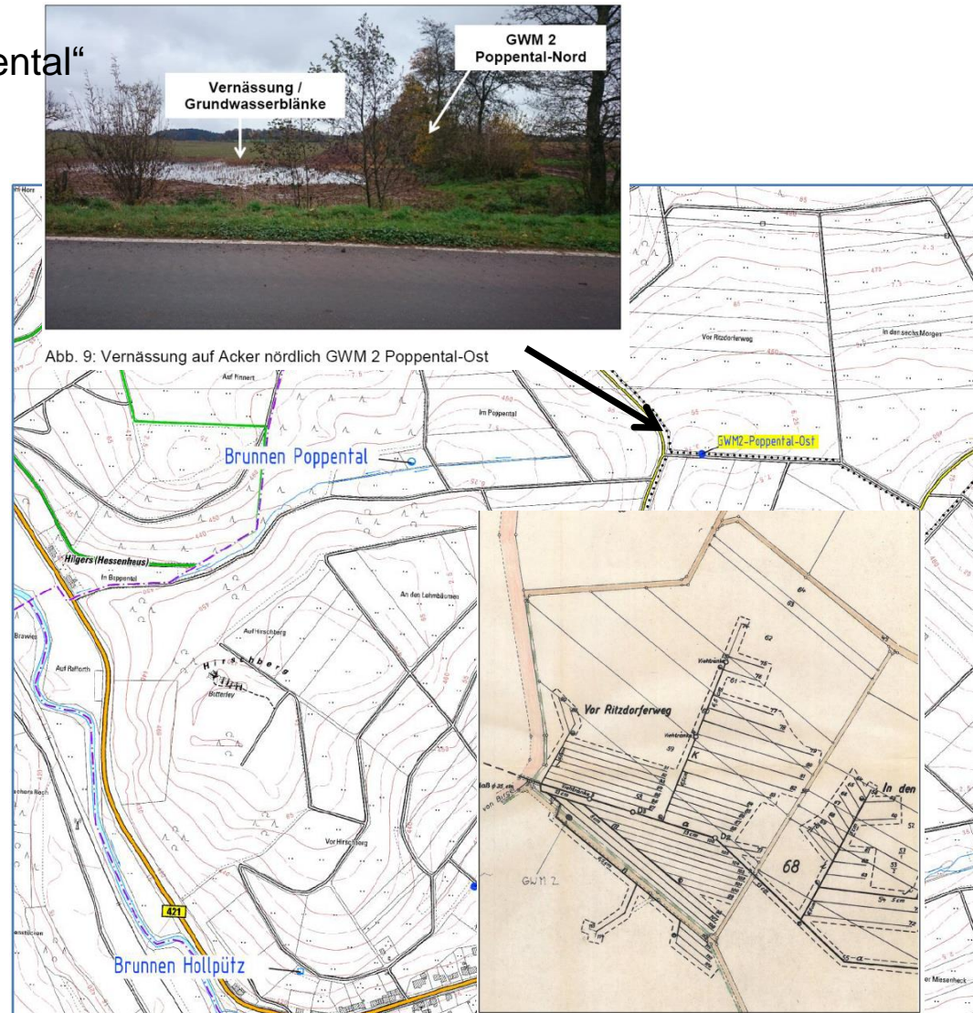
Abb. 9: Auszug Drainageplan der Flurbereinigung Birgel mit Kennzeichnung der Lage der „GWM 2 Poppental-Ost“
