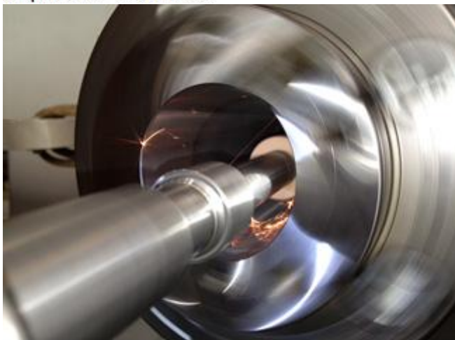
Spindel schleifen zum Nachhonen
