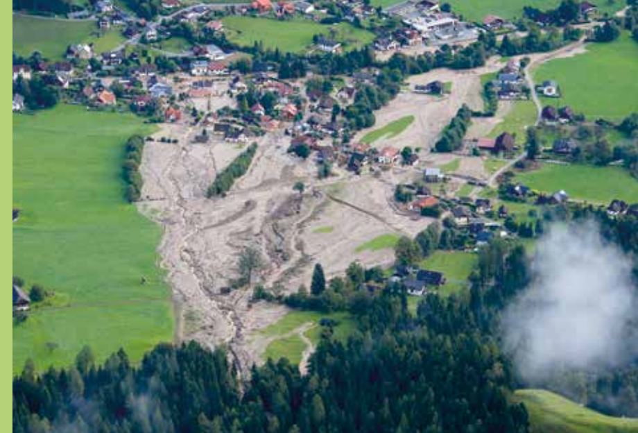
Abb. 7: Ausmaß der Geschiebeablagerungen nach dem zweiten Ereignis
