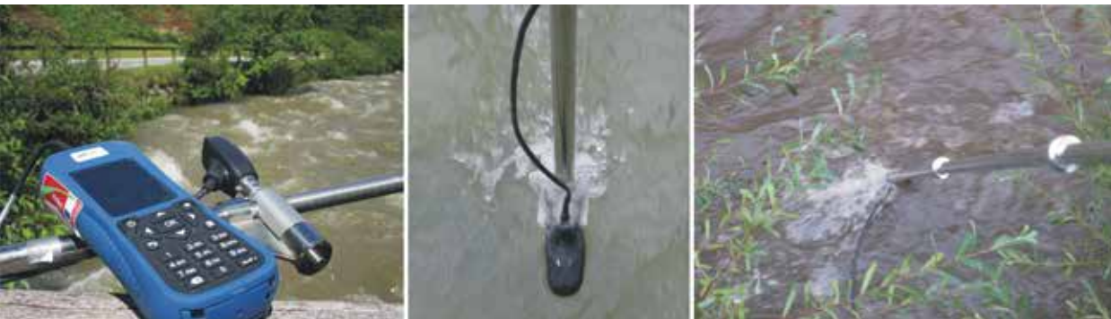
Abb. 1: Abflussmessung mit FlowSens OTT MF Pro
