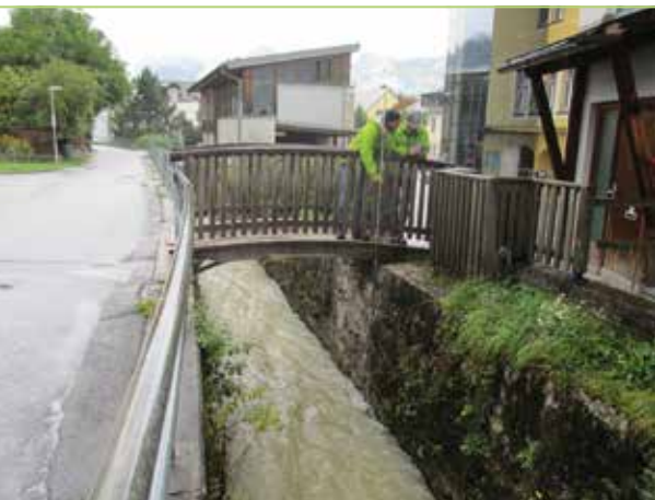
Abb. 6: Beispiel Lichtmessbach im hm 5.3; Profilgeometrie, Fließgeschwindigkeiten sowie Durchflussmenge je Messlotrechte
