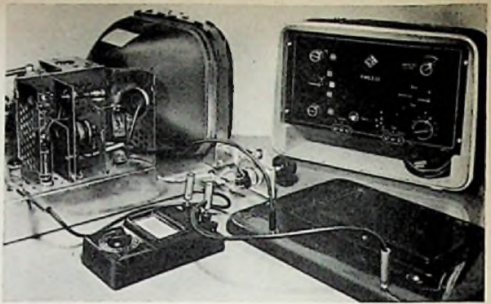
Bild 1. Telefunken-Fernseh-Service-Koffer. Hochspannungsmessung mit dem in den Deckel eingelassenen Vorwiderstand für 18 kV
