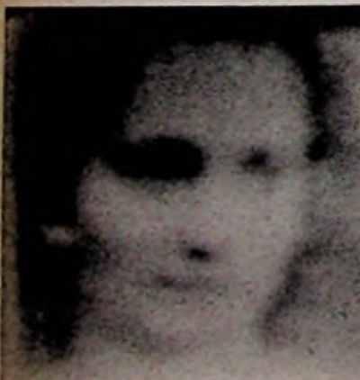
Bild 216. Unrichtige Einstellung des Fokussierstromes
