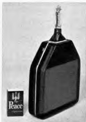
Bild 1. 20-cm-Bildröhre von Hayakawa in flacher Ausführung (Dicke: 56 mm); das Bild kann von beiden Seiten betrachtet werden
