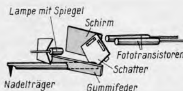
Bild 1. Prinzip des fotoelektronischen Tonabnehmersystems von Toshiba
