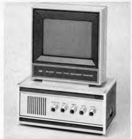
Bild 3. Die flache, von Hayakawa entwickelte Bildröhre in einem Schwarzweiß-Monitor, bestimmt für ein Videoaufzeichnungsgerät
