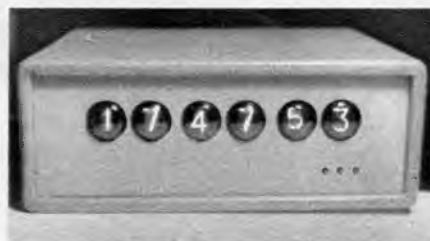
Bild 1. Gesamtansicht des fertigen Gerätes. Rechts sind die drei Schalter zur Eichung zu erkennen
