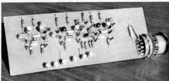
Bild 7. Blick auf die fertige Platine des Minuten-Zehners
