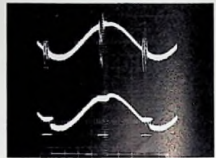
Bild 3. Zündfunkenstörung auf einem Tonsignal (oben). Ausgetastete Störung mit eingeblendetem Ersatzsignal (unten); darunter Triggerimpuls zur Steuerung der Torschaltung (Bild Philips)
