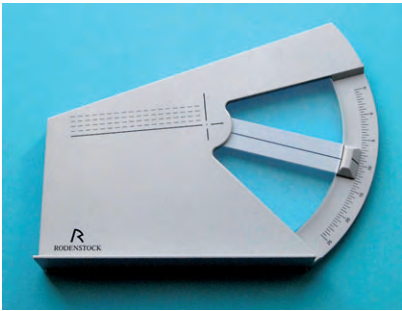
Abb. 17: Messtool zur Bestimmung des Fassungs Scheibenwinkels
