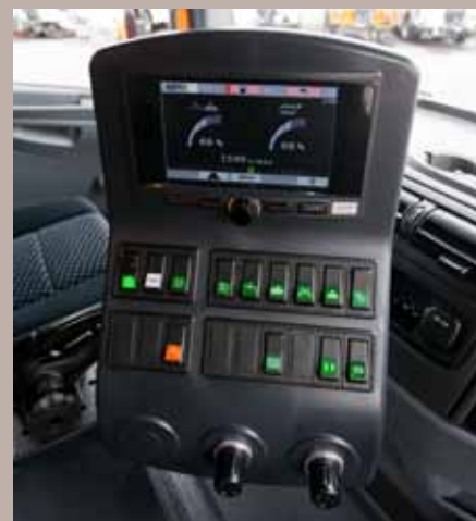
Das Bediengerät JVM-407 von Jetter mit integrierter Steuerung ist das Herz des Automatisierungssystems.
