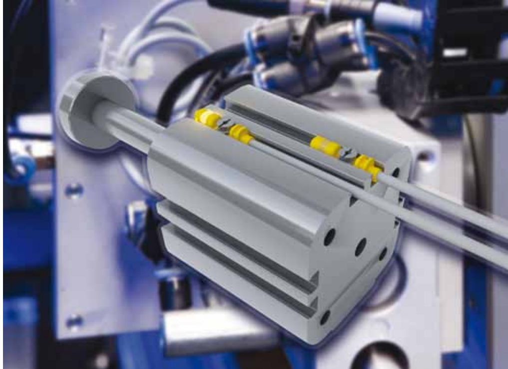
Turcks induktiver LI-Linearwegsensor ist mit 130 µs Signallaufzeit fit für Motion-Control-Anwendungen.
