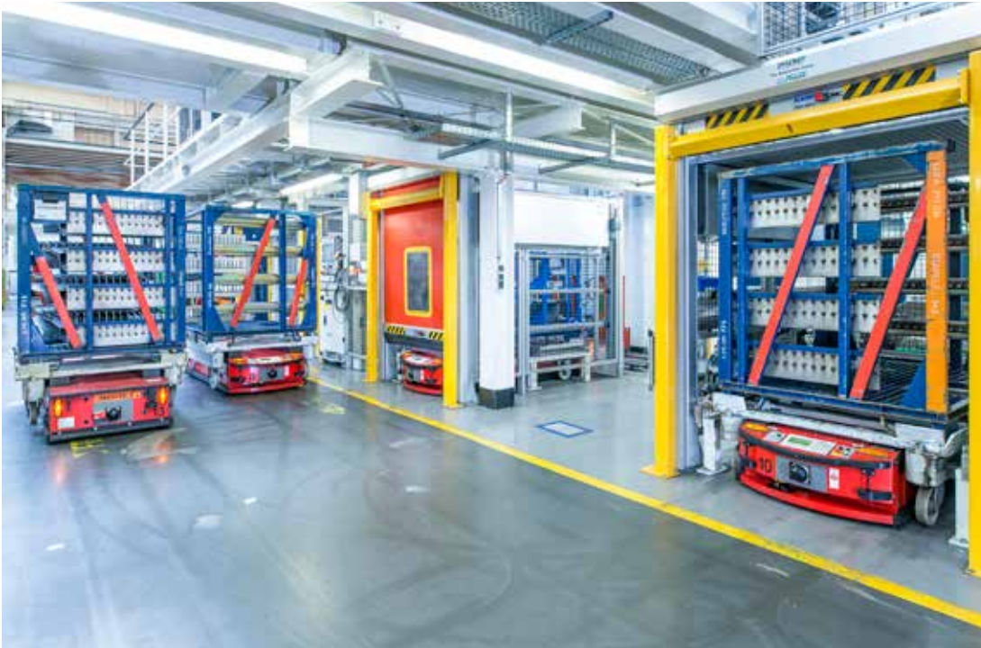
Das FTS bringt die Behälter leer zu und holt sie voll von den 45 Laserschneidmaschinen. Dort werden sie innerhalb einer Schutzeinhausung von Robotern beladen.
