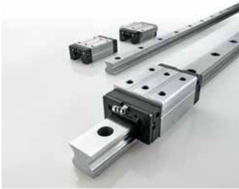
Die O-Anordnung der Laufrillen ermöglicht der Linearführung HDR eine hohe Steifigkeit gegenüber Momenten in rollender Richtung (Mc-Moment).
