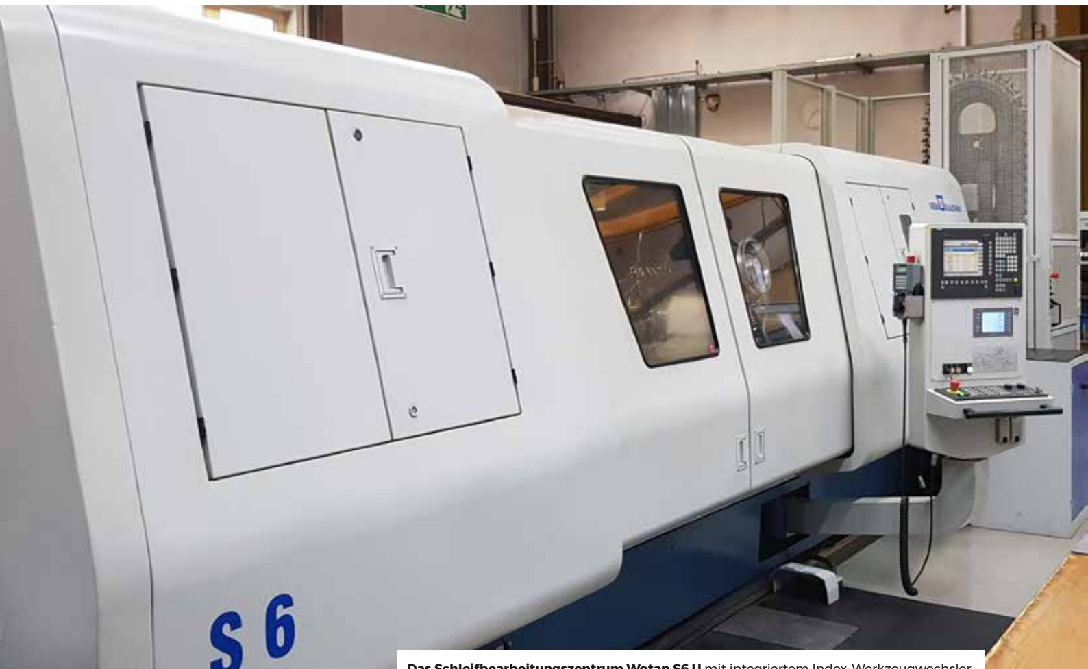
Das Schleifbearbeitungszentrum Wotan S6 U mit integriertem Index-Werkzeugwechsler.
