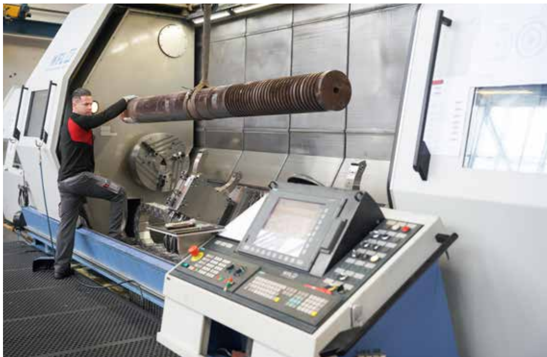
Aktuell hat Wittmann Battenfeld vier verschiedene Millturns im Einsatz. Darunter auch eine M40 und M65, welche vor allem für die Herstellung wellenförmiger Werkstücke Verwendung findet.
