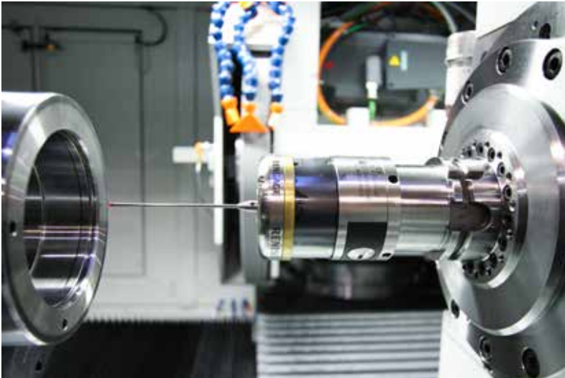
Die WOTAN S6 U ist mit einem Renishaw-Messtaster ausgestattet.
