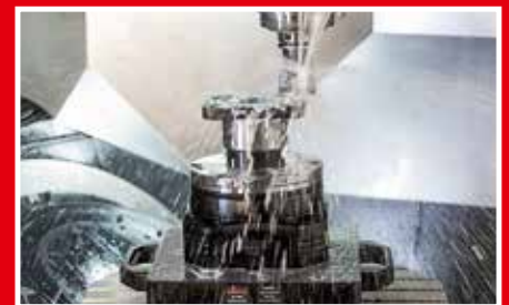
HYDROK – hydraulischer Spannstock mit Adaptionmöglichkeiten
