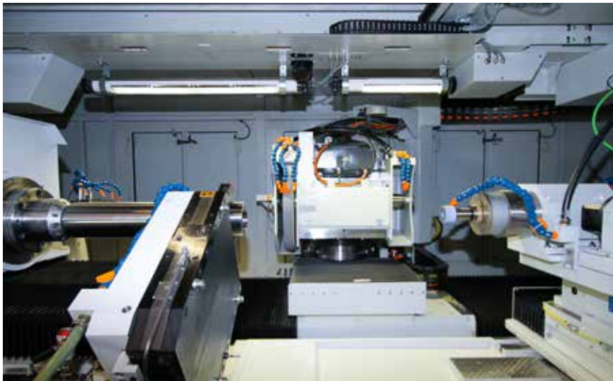
Das Schleifbearbeitungszentrum WOTAN S6 U von Wema verfügt über eine Innen- und Außenschleifeinheit .
