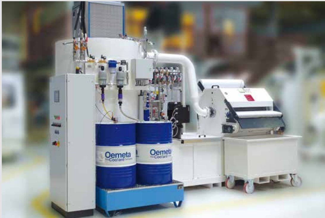
Von der Einzel- bis zur Zentralanlage - ausgehend von einer ganzheitlichen Betrachtung des jeweiligen Prozesses entwickelt Lubot maßgeschneiderte Aufbereitungs-lösungen für Kühl-schmierstoffe.
