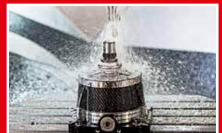
MANOK plus CFK – manueller Spannstock aus Carbon mit Adaptionmöglichkeiten
