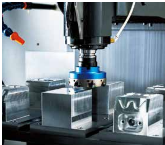
Die leistungsstarke Motorspindel bietet Spindeldrehzahlen in verschiedenen Varianten von 10.000 bis 16.000 U/min.
