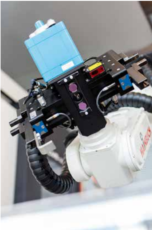
Die Werkstücke werden durch das 3D-Kamerasystem im flexibel einstellbaren Greifer einfach erfasst.
