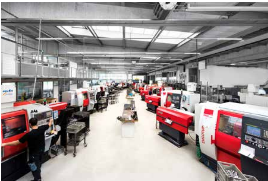
Die oft komplexen Drehteile entstehen auf über 20 CNC-Drehmaschinen in einer modernen Produktionshalle in Fulpmes. Sie werden von Partnerbetrieben gehärtet, geschliffen und oberflächenveredelt sowie im Haus nachbearbeitet, montiert, verpackt und etikettiert. (Bild: Chris Hasibeder)
