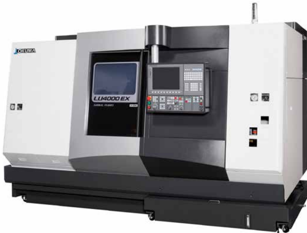
Der jüngste Neuzugang der Marke Okuma beim Wiener Dreh-Spezialisten Kienast & Holzner ist ein SIMUL TURN LU4000EX M 2SC650-Drehzentrum mit zwei Werkzeugrevolvern . (Bilder: x-technik)
