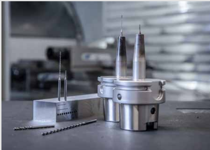
Der WTX - Micro erreicht auch in Mikro-Dimensionen die gewohnt hohe Bohrungsqualität bis 30xD.
