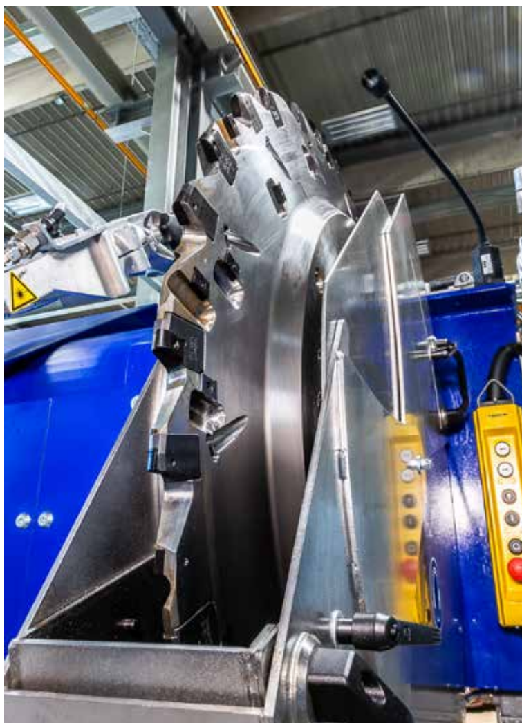
Die speziell für die geforderten Geometrien ausgelegten Wendeschneidplatten überzeugen mit hoher Performance und langer Standzeit, selbst bei schwer zu bearbeitenden Werkstoffen.
