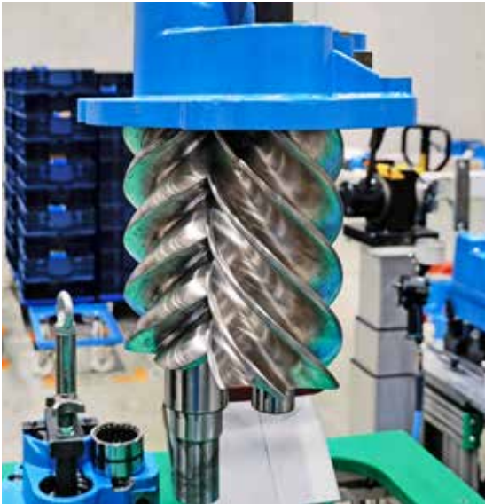
Teilmontierte Schraubenverdichter-Baugruppe , bei Boge bestehend aus zwei Rotoren und dem blau lackierten Lagerdeckel.
