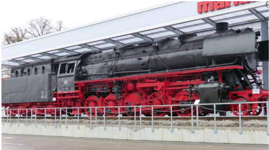
Das Original im Stammwerk von Märklin: Die Lok hat ein Gewicht inklusive Tender von 169 Tonnen und verfügt über 2.100 PS.
