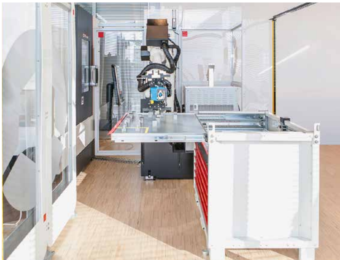
Optionaler Werkstückspeicher: Auf der Grundfläche einer Europalette stehen auf zig ausziehbaren Böden insgesamt zwölf Quadratmeter Ablagefläche für die Werkstücke zur Verfügung.
