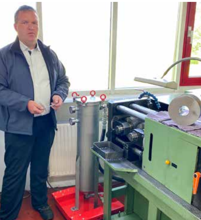
Tobias Kuolt, Geschäftsführer der Paul Kuolt Feinmechanik, und die Maschine von Rollwalztechnik Abele + Höltich, die über eine Walzkraft von bis zu 25.000 kN verfügt .
