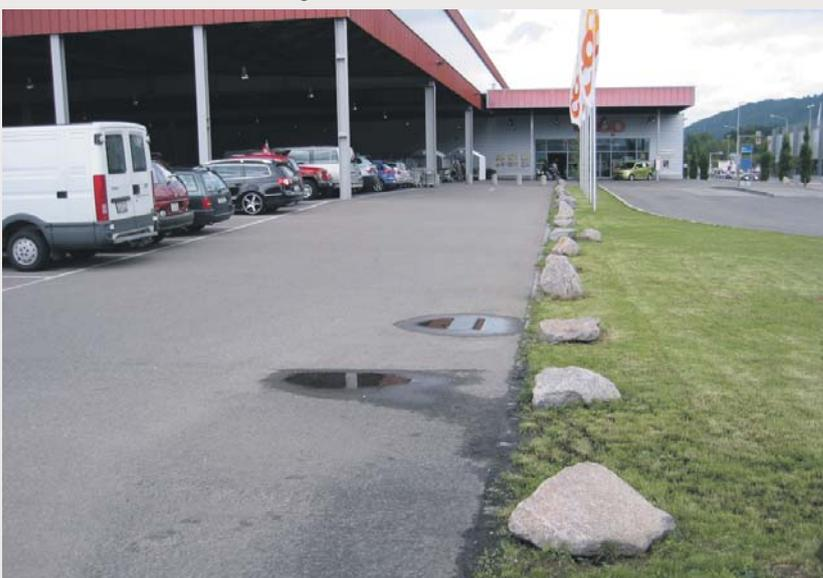
Beim Coop Megastore „Silbern“ in Dietikon fliesst das Regenwasser der asphaltierten Parkplatzfläche direkt auf der Oberfläche in die angrenzende Grünfläche, wo es versickern kann. Die Versickerung des Regenwassers durch die belebte Bodenschicht ist übrigens auch bei Wohn- und Bürobauten die günstigste, effizienteste und ökologisch beste Variante.
