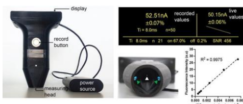
Abb. 1: Links: Autarkes Handgerät mit Batterie. Oben rechts: Display. Mitte: Messöffnung. Unten rechts: Gemessener Wert versus tatsächlicher Markerkonzentration.
