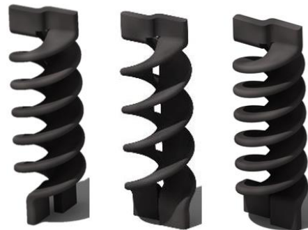
Illustration 2: Verschiedene Doppelhelix Geometrie-Varianten.
