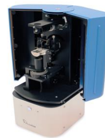
Abb. 1: Vom Prototyp zum Produkt: Das im Projekt entwickelte Messgerät PHELOS zur Bestimmung des winkelaufgelösten Abstrahlverhaltens von OLEDs.
