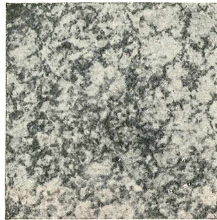
Abb. 7. Stahl „H c “ (0,40% C, 0,90% Mn, 0,90% Si). Geätzt mit Xylol-Pikrinsäure. Abbildungsmaßstab 550:1.
