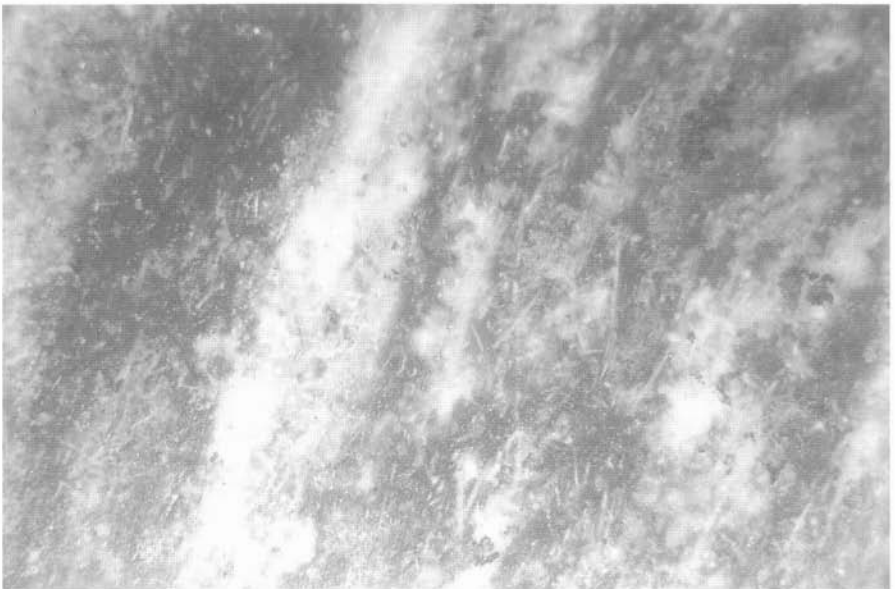
Foto 8: Weiße Umwandlungsreste von Schwammnadeln im Spiculitmaterial der Dreieckspitze in Foto 4, erkennbare statistische Einregelung parallel zur Farbstreifung; Bildbreite: 2,8 mm, Foto: J.Taucher
