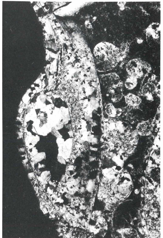
Abb. 5 Dieselbe „Perle“ mit polarisiertem Licht unter gekreuzten Nicols – Länge des grobspätigen Nucleus 3 mm.
