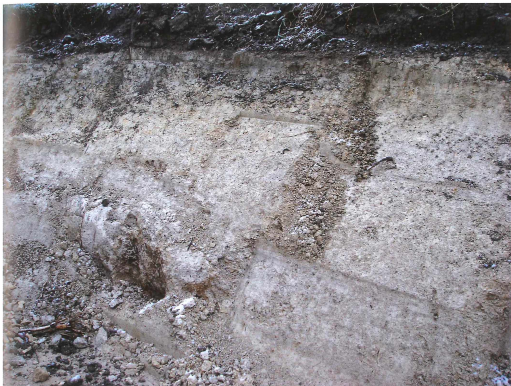
Abb. 1: Etwa 1,5 m mächtiger Aufschluss bei Rittersbach mit einer 30 cm starken, rasch auskeilenden Kalklage, die von Kalkgrus und Tonen überlagert wird
