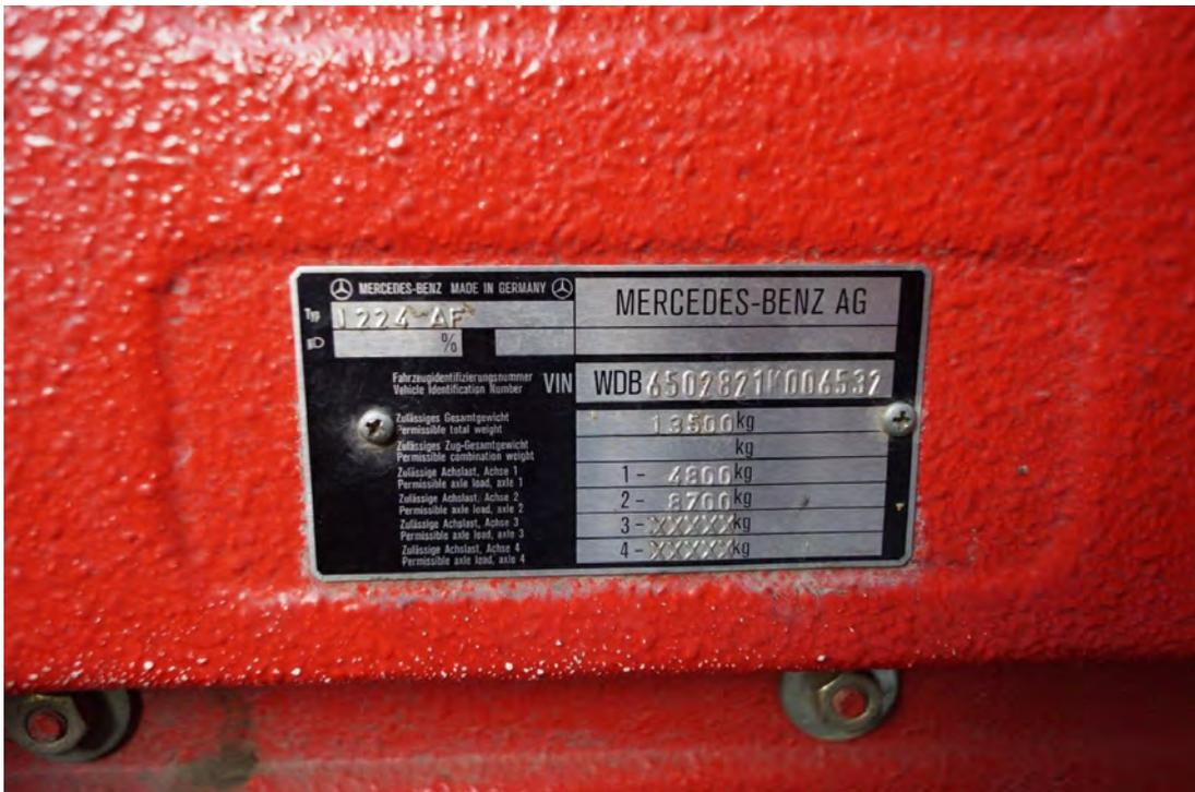
Bild 18 : Typenschild Fahrgestell
