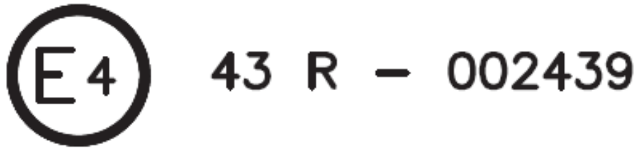
Bild 5: Beispiel für die Kennzeichnung von Sicherheitsglas
