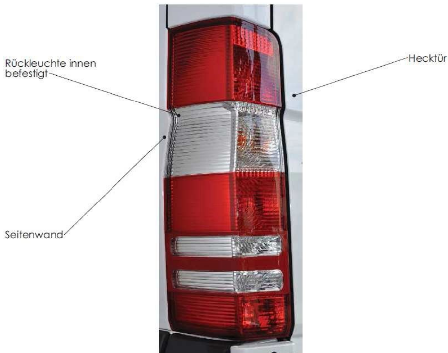
Bild 31: konstruktive Sicherung einer Heckleuchte
