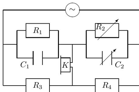
Die unbekannte Kapazität  $C_1$  und der unbekannte Widerstand  $R_1$  können mit Hilfe der oben angegebenen Schaltung bestimmt werden. Man variiert dazu den Kondensator  $C_2$  und den Widerstand  $R_2$  solange, bis der Ton im Lautsprecher  $K$  ein Minimum erreicht oder verschwindet. In diesem Fall gilt
