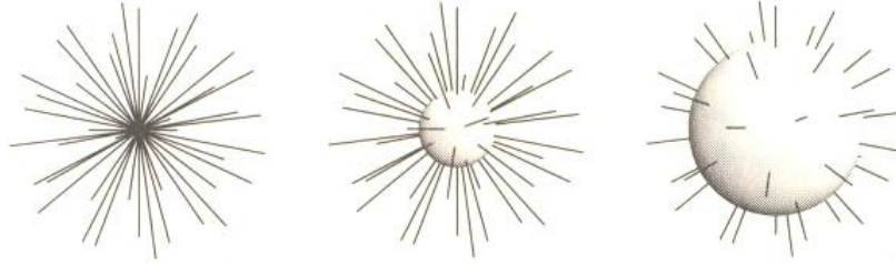
Abbildung 3: Geht von einer Masse eine konstante Anzahl von Schwerefeldlinien aus, die sich radial ausbreiten, so schneidet dieselbe Anzahl Feldlinien eine Sphäre mit beliebigem Radius, wobei die Oberfläche der Sphäre sich quadratisch mit dem Radius vergrößert. Die Stärke der Anziehungskraft ist dabei der Dichte der Schnittpunkte auf der Sphärenoberfläche proportional und nimmt somit mit dem Abstand quadratisch ab [56](S.65).
