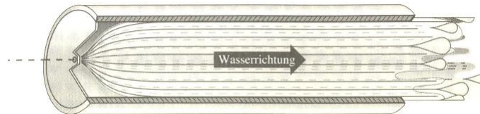
Abbildung 4: Das Wasser breitet sich zunächst in drei Dimensionen aus, ehe es dann nur noch entlang der einen Dimension des Schlauches weiterfließt [56](S. 67).
