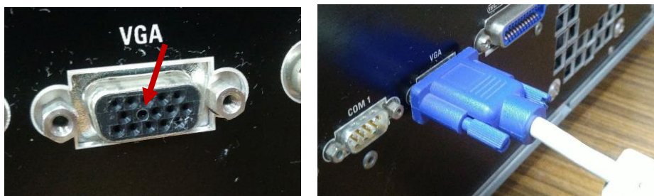
Abbildung 5: erst wenn man dieses Loch nachbohrt, passt ein normaler VGA-Stecker
