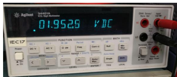
Abbildung 18: links: IKEA-Batterie im UPL; rechts: nur noch knapp 2V auf der alten Lithiumzelle- das ist zu wenig
