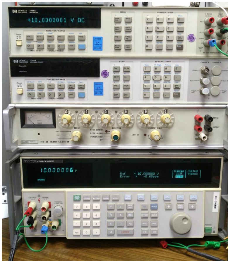
Abbildung 65: finden 16kHz im Netz sicher auch nicht witzig: Fluke 5700A, HP3458 und HP3245A
