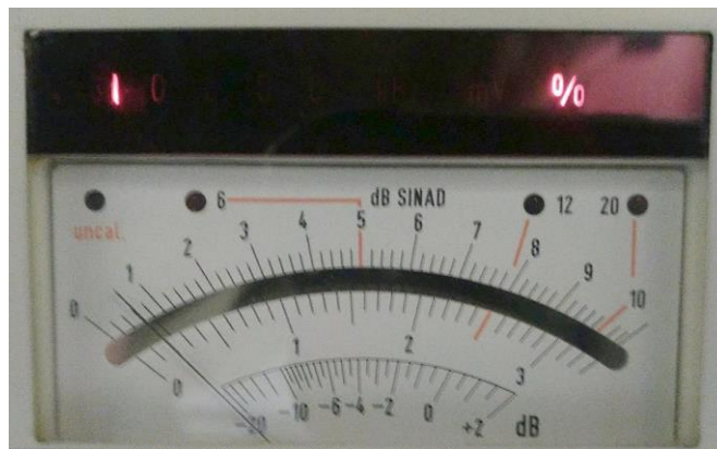
Abbildung 53: minimale THD+N Anzeige des SMDU: etwa 0,07%
