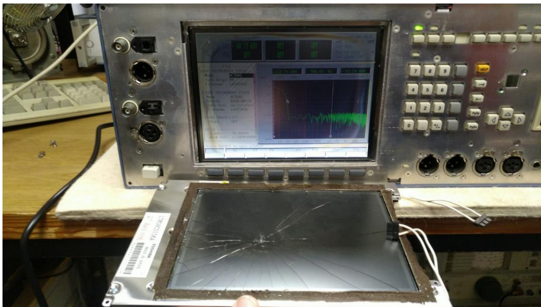
Abbildung 9: Dank unzureichender Verpackung: das -als Ersatz für das gesplitterte Display (vorn) bestellte- Ersatzdisplay aus China kam leider ebenfalls defekt hier an (siehe Schatten- und Moirée-Effekte im UPL-Display) :-)
