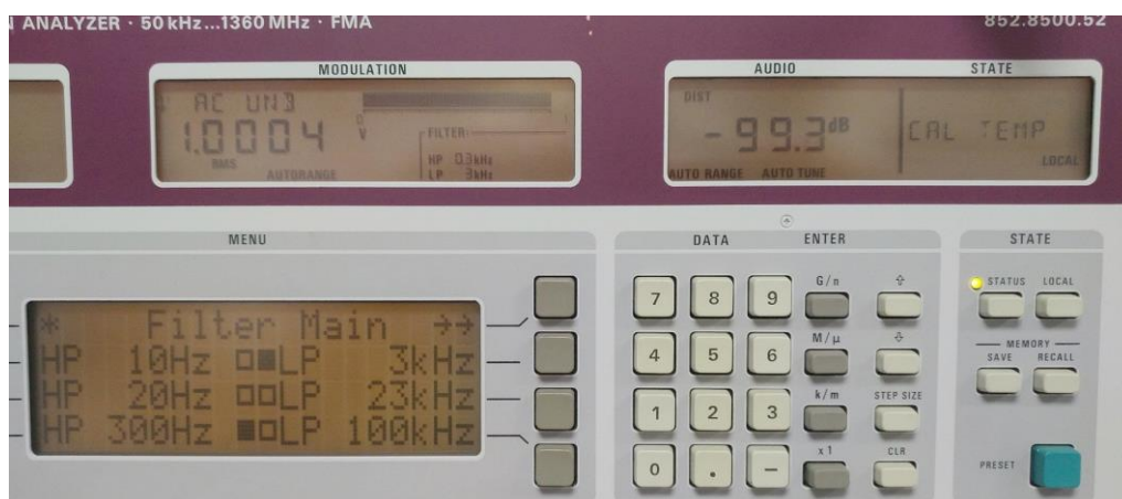
Abbildung 51: der R&S FMA schafft ebenfalls fast -100\text{dB} ! THD+N
