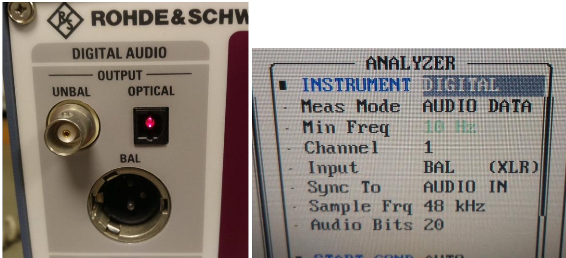
Abbildung 48: rot leuchtender Transmitter und die Möglichkeit, "DIGITAL" als Betriebsmode auszuwählen zu können, zeigen uns, dass die Option nun erkannt wurde!
