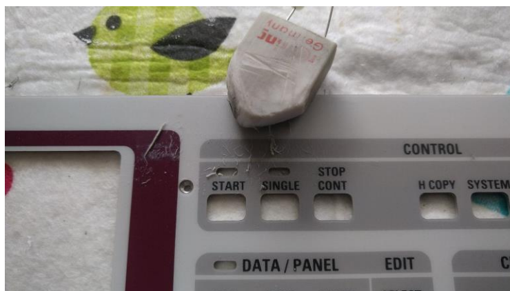
Abbildung 20: Tipp: Reste von Aufklebern oder Verschmutzungen kann man gut mit einem weichen Radiergummi abrubbeln!
