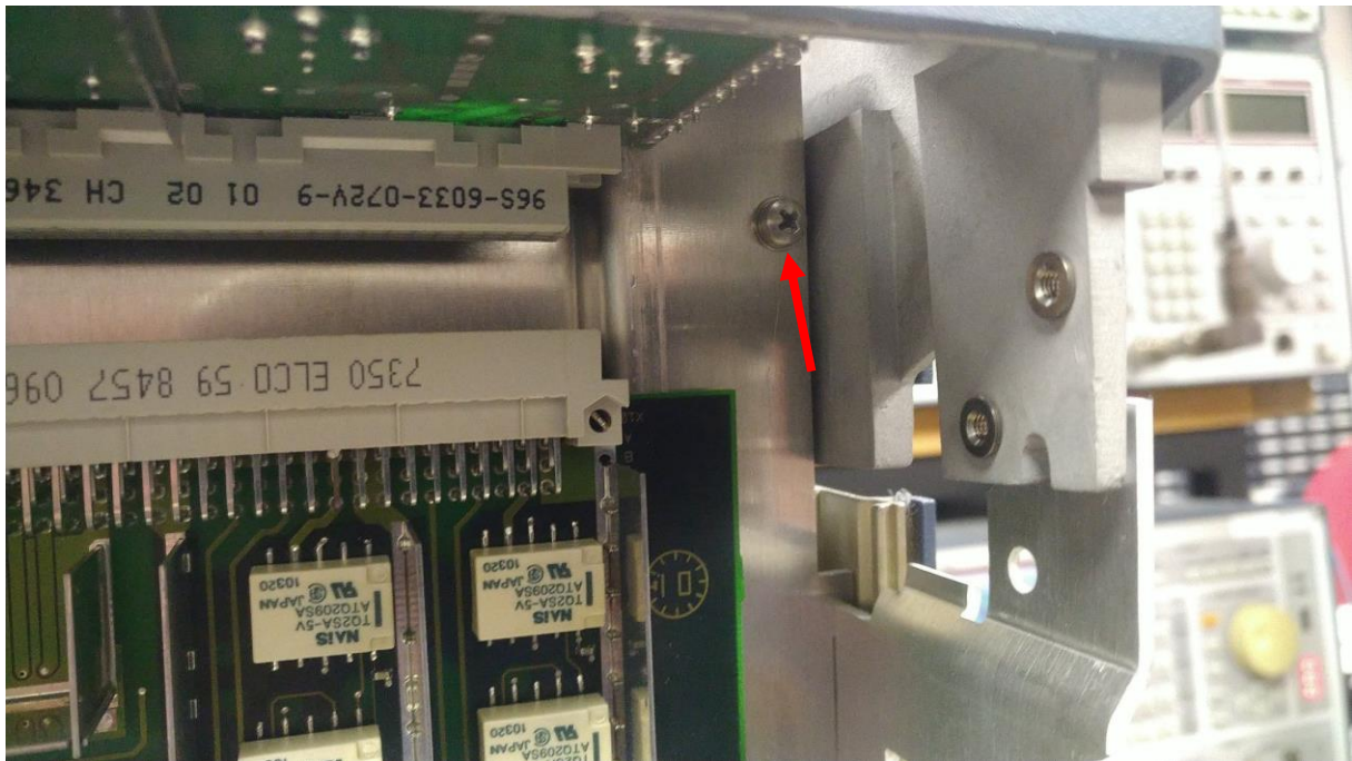
Abbildung 40: Schraube Nr. 3 kommt zum Vorschein+
