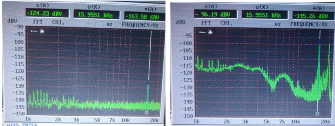
Abbildung 64: Messung Spektrum mit Max-Hold über mehrere Minuten. Links: PV offline, Rechts: PV online (bitte nur auf den Teil ab 10kHz aufwärts gucken, der Rest war ein ungewollter Impuls vom Einschalten des Deckenlichts)
