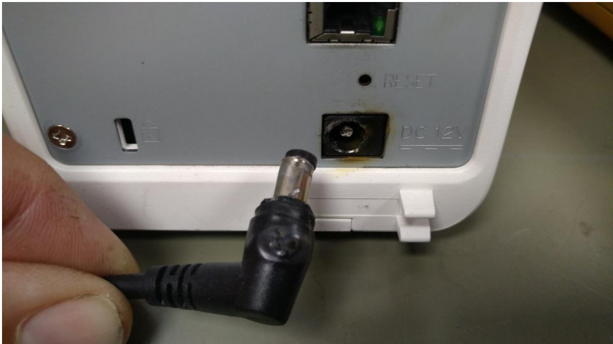
Abbildung 19: auf dieser QNAP TS212 Netzwerkfestplatte speichere ich alle meine Reparaturberichte. Durch meine Nachlässigkeit beim jährlichen Reinigen baute sich ein hoher Übergangswiderstand auf, erhitze und verschmorte schließlich den Stromversorgungsstecker- und fiel dann mit Kurzschluss aus!
