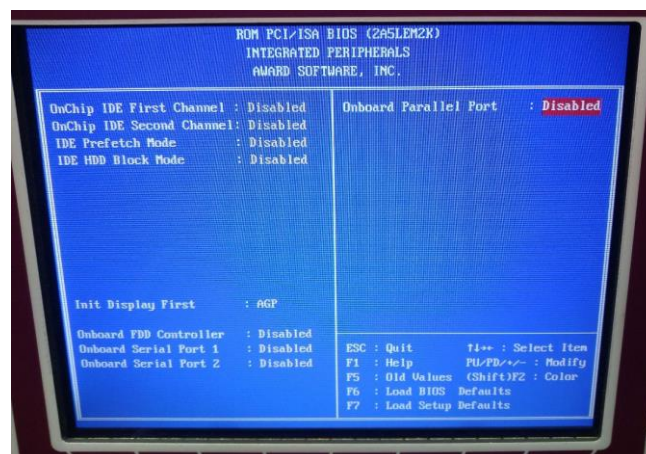
Abbildung 29: beim UPL ganz wichtig: die internen Controller müssen alle DISABLED werden, denn der UPL hat eigene Festplattencontroller an Bord!
