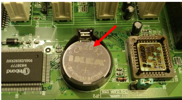
Abbildung 18: links: IKEA-Batterie im UPL; rechts: nur noch knapp 2V auf der alten Lithiumzelle- das ist zu wenig
