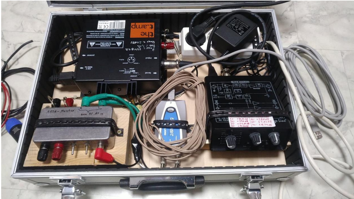
Abbildung 3: mein selbstgebauter NF-Messkoffer für Lautsprecher- und Schallmessungen
