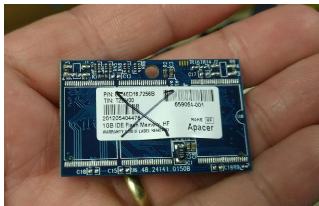
Abbildung 32: Flash-Modul mit 1GB Speicher
