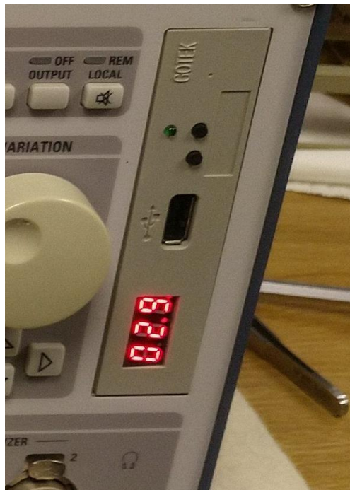
Abbildung 37: so eine USB-Floppy musste ich mir einbauen!
