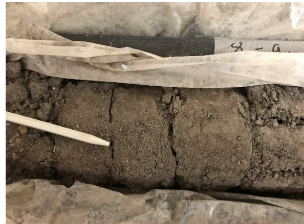
Bohrkern 11–12 m: Mehrheitlich fester Bohrkern.
