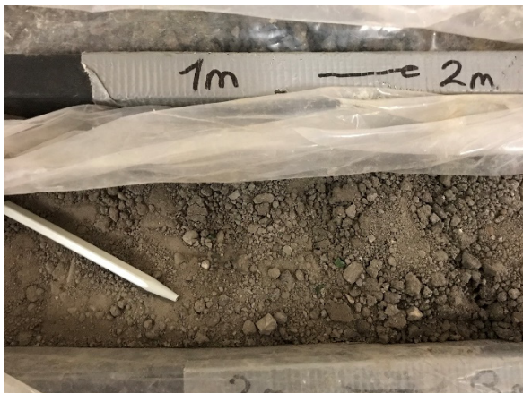
Bohrkern 18–19 m: Hellgrauer, pulvriger Abschnitt.
