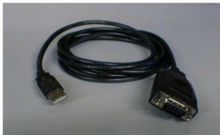
Legen Sie die Installations-CD mit dem Schnittstellentreiber in das Laufwerk ein. Danach stecken Sie den Konverter in einen freien USB-Port am PC.
