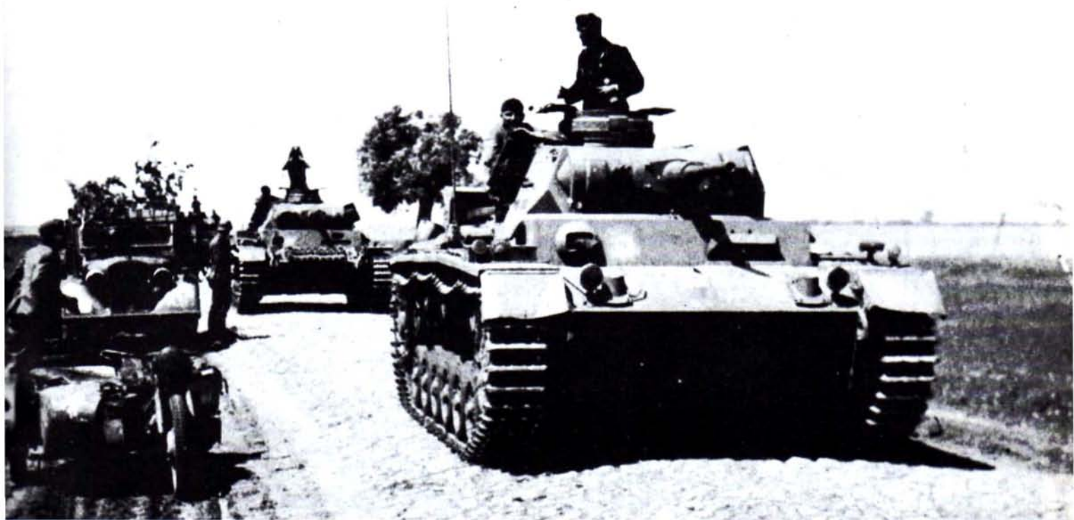
Kampfpanzer III der Ausführung J — hier noch mit der kürzeren 5-cm-Kwk L/42. Es war die letzte Ausführung mit den »kürzeren« Kanonen 3,7 und 5 cm. Es ist ein Panzer der 11. Panzer-Division.
