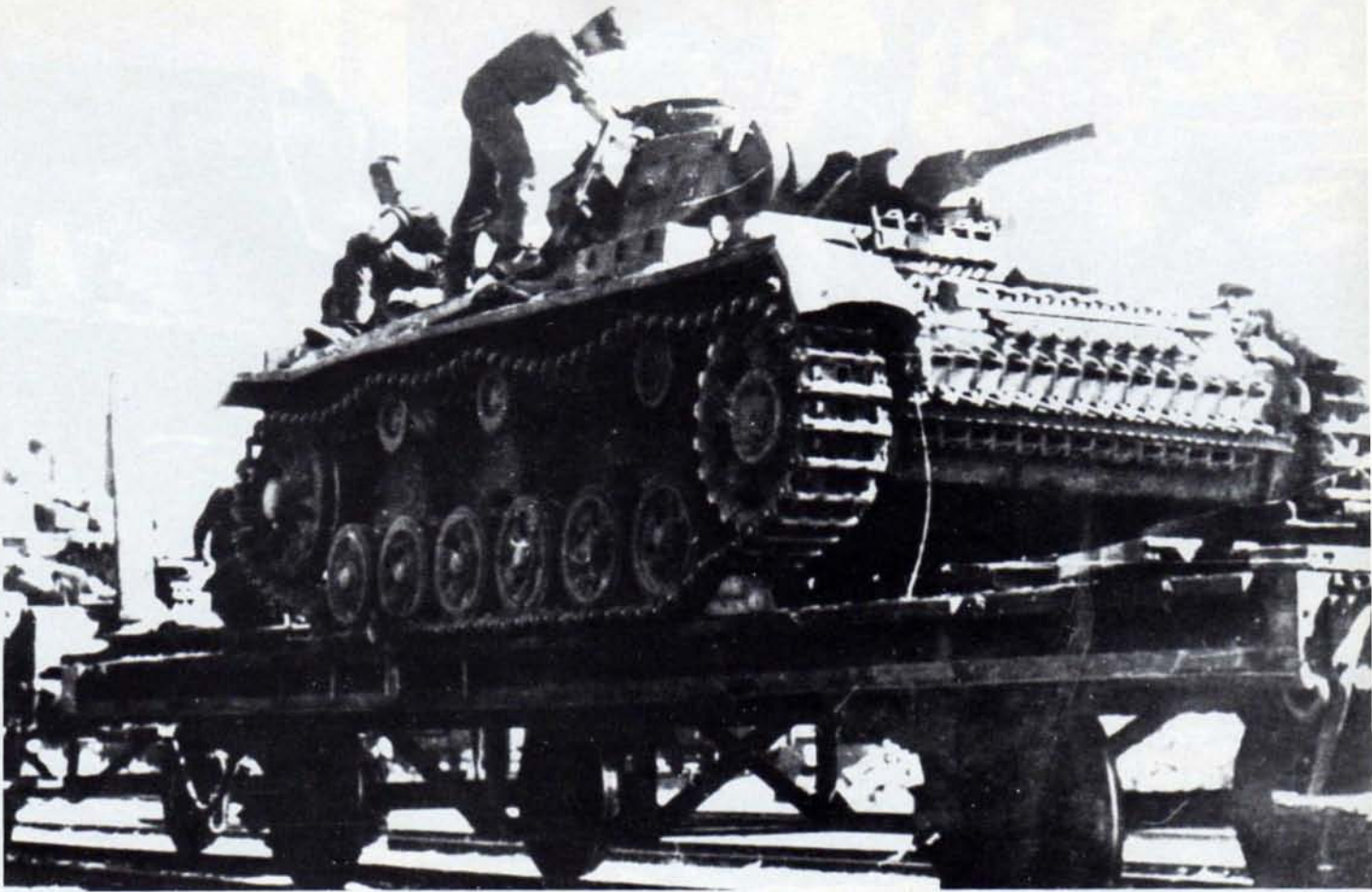
Auf beiden Bildern ist der III H gut anzusprechen, da auf beiden erkennbar ist, daß sich jeweils die vorderste Stützrolle relativ nah am Antriebsrad befindet. Oben: Während eines Bahntransportes, unten: Der voll entwickelte Panzerangriff von mindestens einer Abteilung. (1xBA)
