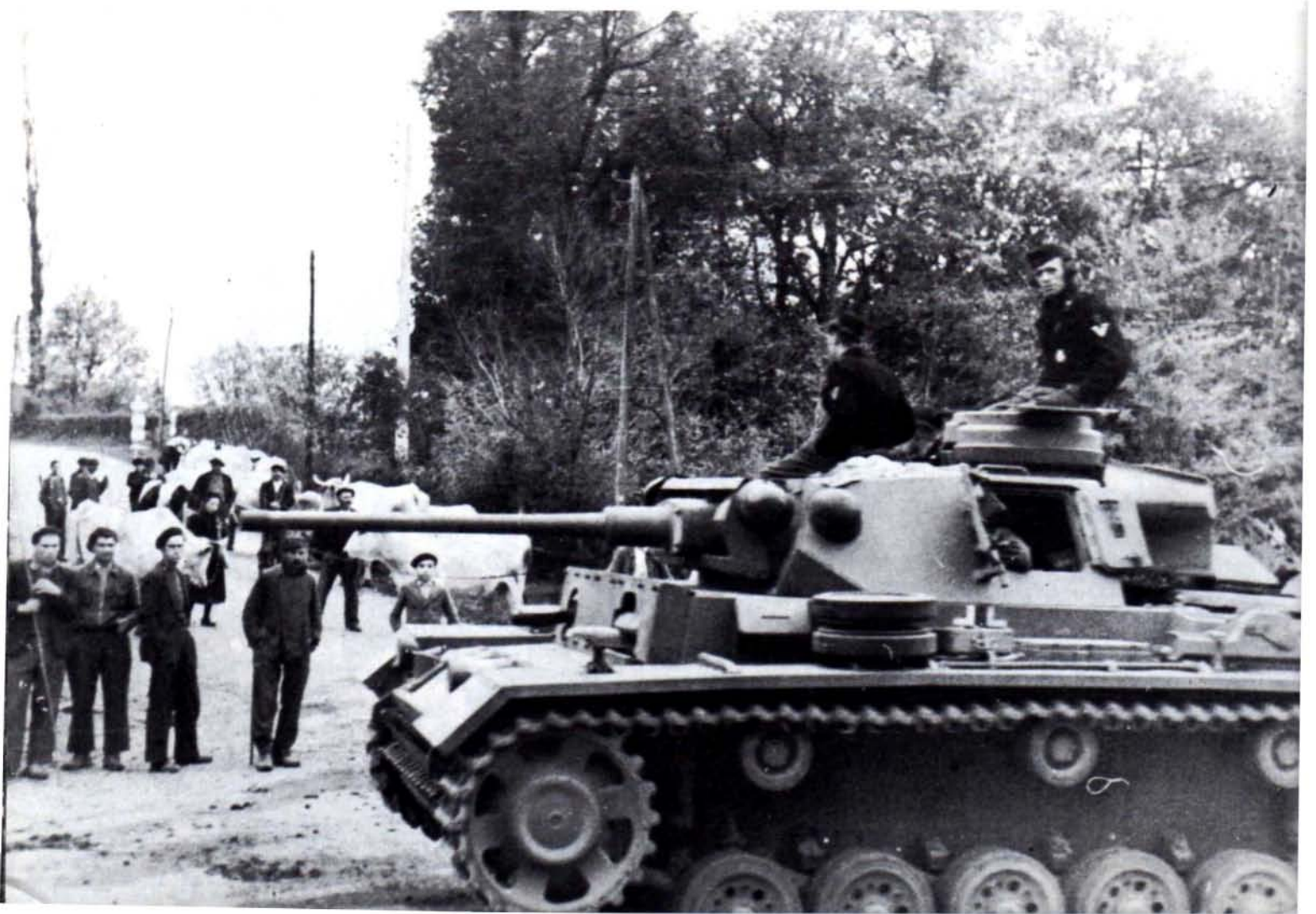
Zwei Kampfpanzer III L. Zwar fehlt bei beiden die Schottenpanzerung vor dem Turm, doch ist der dafür vorgesehene Stützrahmen zu erkennen. Beide Fotos wurden während der Besetzung Südfrankreichs im Herbst 1942 aufgenommen. Oben während des Marsches durch die Canebière von Marseille.
