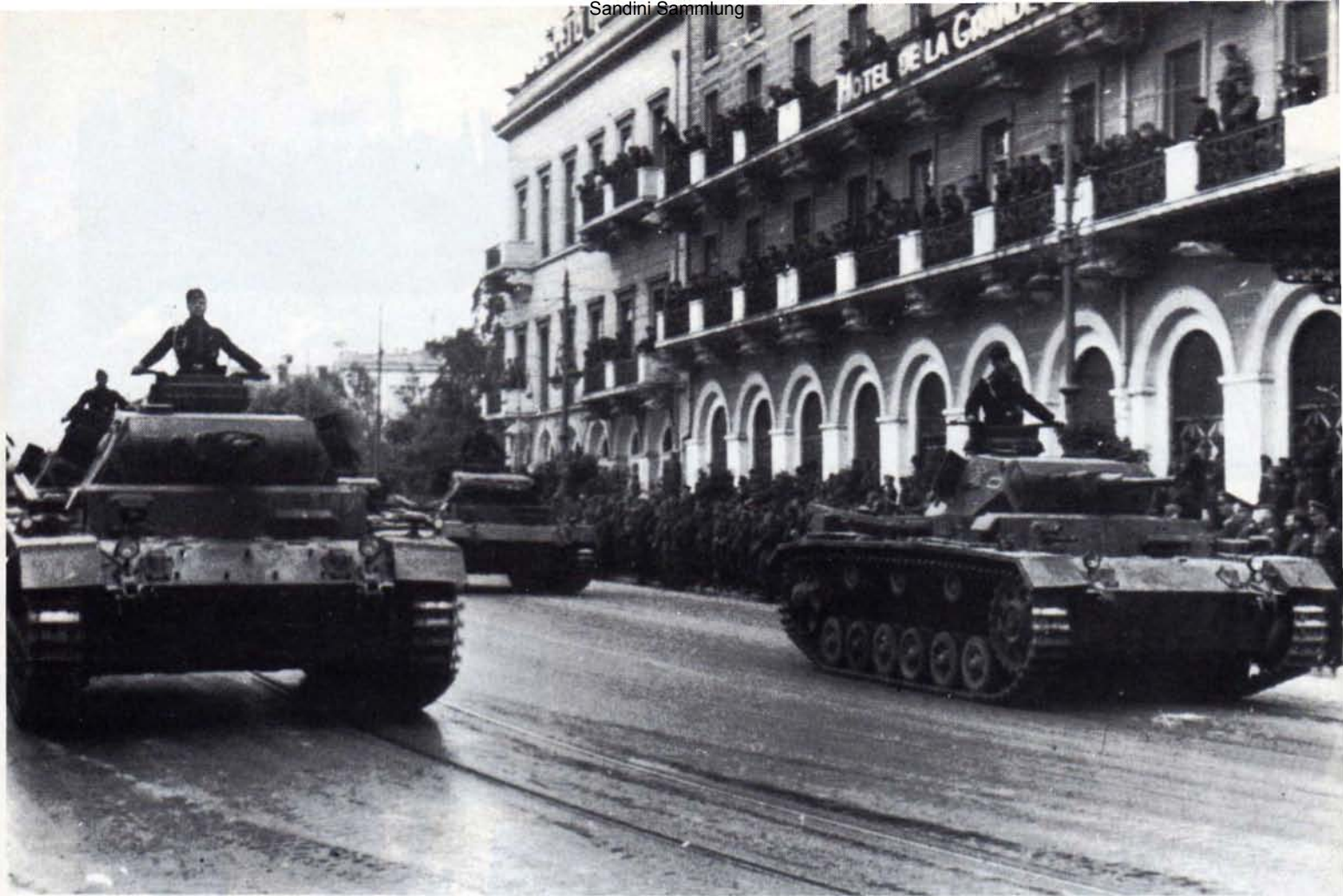
Oben: Parade des Panzer-Regiments 31 in Athen (1941) vor dem »Hotel de la Grand Bretagne«. Links auf dem Foto ein III G mit Panzerverstärkungen. Zwar sieht der rechte auch wie ein III G aus, doch hat er noch die ältere Kommandantenkuppel. Unten: Ein Kampfpanzer III G mit wegretuschierter Seiten- und Fahrerluke. Vermutlich war dieses Bild zur Veröffentlichung in der Auslandpresse bestimmt und zeigte der Panzer an den retuschierten Stellen das Divisionszeichen.
