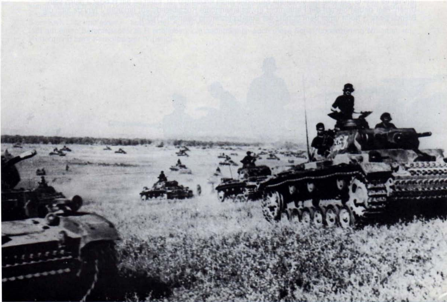
Auf beiden Bildern ist der III H gut anzusprechen, da auf beiden erkennbar ist, daß sich jeweils die vorderste Stützrolle relativ nah am Antriebsrad befindet. Oben: Während eines Bahntransportes, unten: Der voll entwickelte Panzerangriff von mindestens einer Abteilung. (1xBA)
