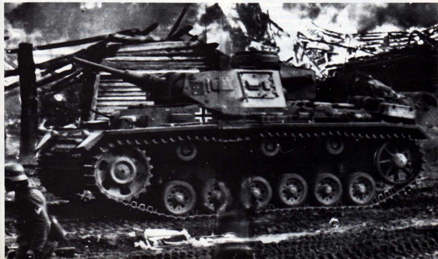
Auch diese beiden Kampfpanzer III sind klar als Ausführungen J zu erkennen. Die nun aus einer Panzerplatte bestehende Frontpanzerung hatte eine Stärke von 50 mm. Beide Aufnahmen stammen aus Rußland 1942 (1xBA)
