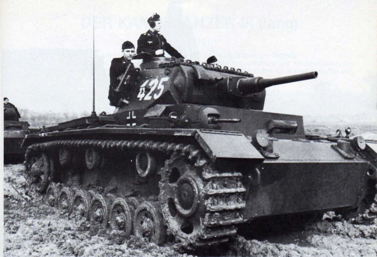
Auch diese beiden Kampfpanzer III sind klar als Ausführungen J zu erkennen. Die nun aus einer Panzerplatte bestehende Frontpanzerung hatte eine Stärke von 50 mm. Beide Aufnahmen stammen aus Rußland 1942 (1xBA)
