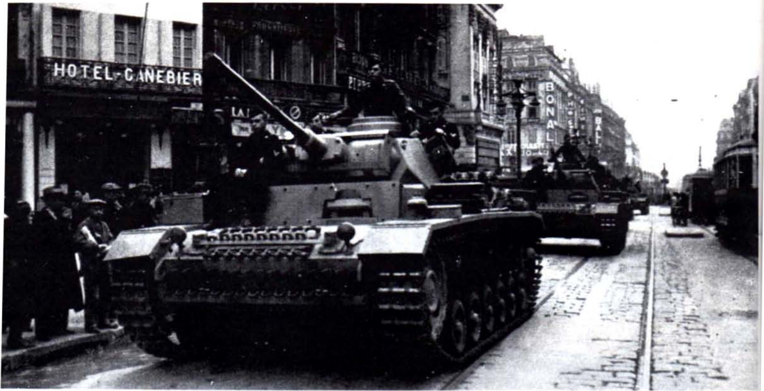
Zwei Kampfpanzer III L. Zwar fehlt bei beiden die Schottenpanzerung vor dem Turm, doch ist der dafür vorgesehene Stützrahmen zu erkennen. Beide Fotos wurden während der Besetzung Südfrankreichs im Herbst 1942 aufgenommen. Oben während des Marsches durch die Canebière von Marseille.
