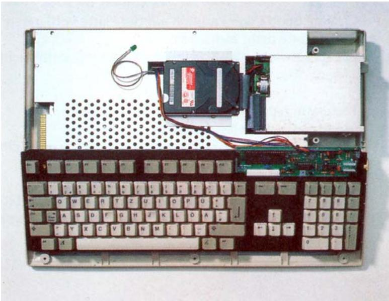
*Abb. III.6 AMIGA 500 offen, Interface u. Platte eingebaut*
