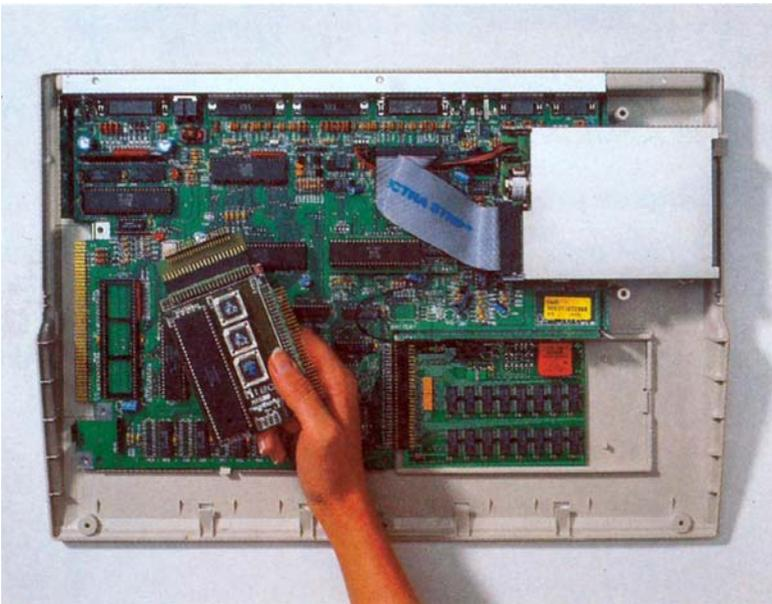
*Abb. III.4 AMIGA 500 offen, Interfacekarte im Einbau*
