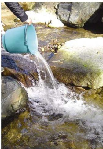
**Abbildung 32: Einbringung des aufgelösten Salzes an der Messstelle Prätisbach in Pöllau bei Hartberg am 15.10.2003**
