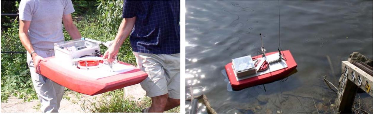
**Abbildung 50: ADCP Messgerät des hydrographischen Dienstes Slowenien bei der Messung am Pegel Mureck/Mur**
