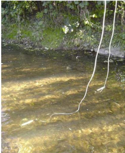
**Abbildung 33: Messsonden zur Messung der elektrolytischen Leitfähigkeit an der Messstelle Prätisbach in Pöllau bei Hartberg am 15.10.2003**
