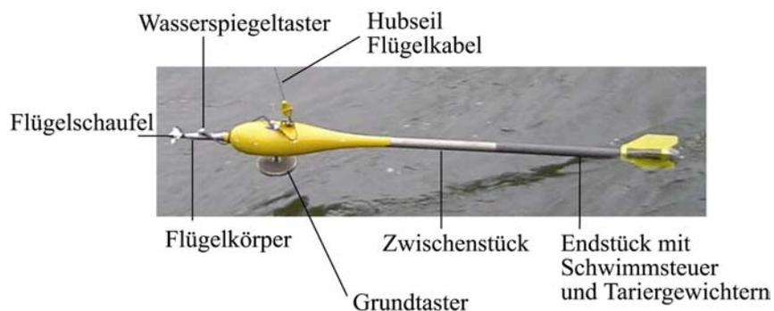
Abbildung 22: Messflügel mit Schwimmflügelausrüstung (Foto vom 25.11.2003, Messstelle Bruck/Mur)
