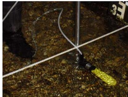
**Abbildung 25 und 26: Elektromagnetische Messsonden (Nautilus), (Messstation Safen bei Pöllau am 15.10.2003)**
