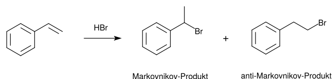
Abbildung 8.3: Reaktionsschema der Hydrobromierung von Styrol zu (1-Bromethyl)benzol und (2-Bromethyl)benzol.
