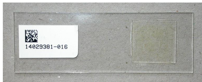
Abbildung 5.12: Abdeckung des Sediments mit einem Deckglas.
