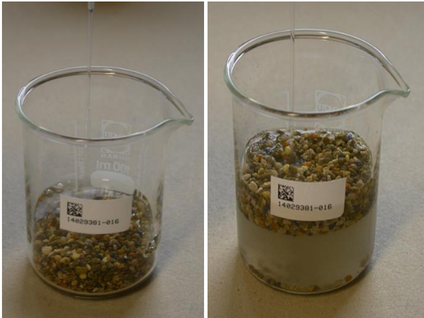
Abbildungen 5.5 und 5.6: Die Probe wird in ein Becherglas überführt und nach Bedarf destilliertes Wasser zugegeben, damit die Pollenhöschen zerfallen.
