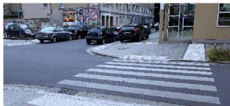
Abb. 15: Barrierefreie Fahrbahnquerung mit Tief- und Nullbord
