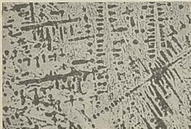
Abb. 3. Schliffbild von weißem Roheisen mit 3,9% Kohlenstoff.
