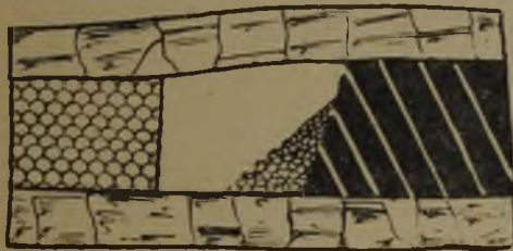
Abb. 18. Der Stoß muß am Liegenden vorgesetzt werden.
