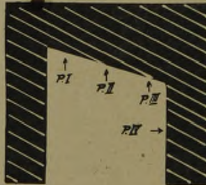
Abb. 14. Aufhauen mit schrägem Stoß und Härtepunkte
