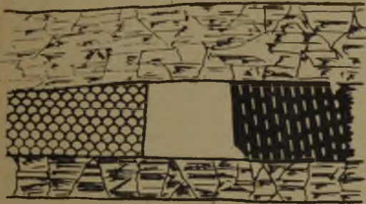
Abb. 16. Der Fuß der ersten Lage ist angehauen.
