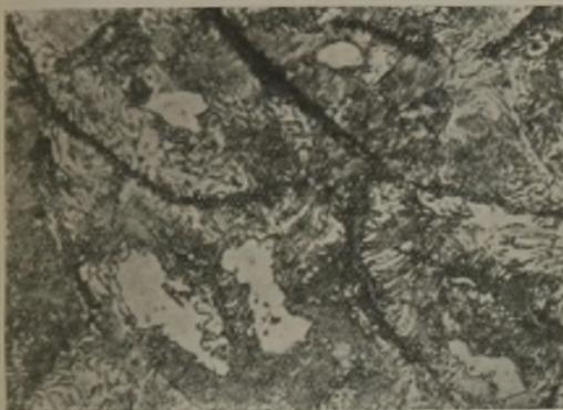
Abbildung 3. Gefüge einer Legierung mit 2,75 % Si und 0,5 % W. Aetzung II.
