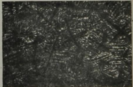
Abbildung 4. Schmelze 2 (mit 5% CaS). Vergr. 101mal. Gewöhnliches Licht. Zahlreiche wohlausgebildete Dendriten von Oldhamit (CaS) in feinkristallinem Eutektikum.
