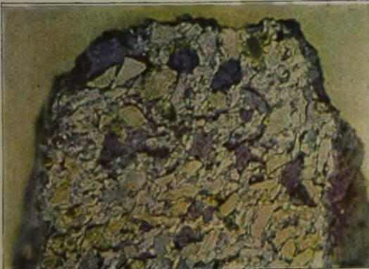
Abbildung 3. Quarzschamottestein, Anschliff, nicht vorbehandelt, Bindeton und Schamotttekörner ungefärbt, Quarzmagerung blau gefärbt, vereinzelt braune Eisenoxydflecke.
