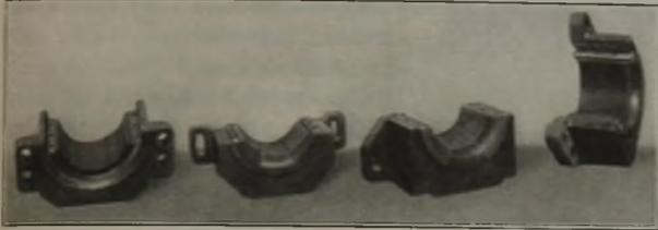
Bild 15. Mit Kunstharz ausgefütterte Einbaustücke einer Trio-Profilstahlstraße.
